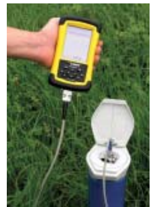
Komfortables Auslesen und Kontrollieren von Loggerdaten mit Mobilcomputern
