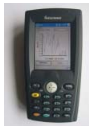
Mobilcomputer (PDA) mit Wasserstandsgraphik zur Vorortkontrolle
